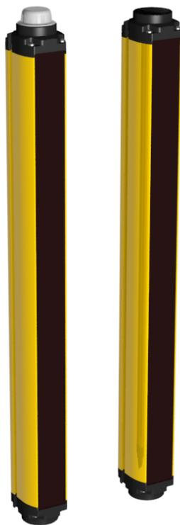
Le Système SGS (Safety Grid System) de Banner est un « rideau lumineux » composé de deux éléments, redondant, fonctionnant selon le principe d'une barrière optoélectronique et contrôlé par microprocesseur. Les modèles standard sont des systèmes à 2 faisceaux (espacement des faisceaux de 500 mm), à 3 faisceaux (espacement des faisceaux de 400 mm) ou à 4 faisceaux (espacement des faisceaux de 300 mm et 400 mm).
