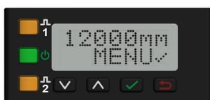
Abbildung 4. Display in der Betriebsart „Betrieb“
