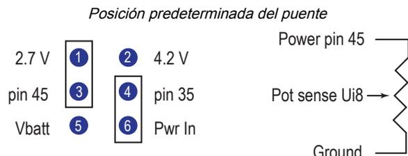
5. Verifique que los puentes sigan en su posición predeterminada. Uno de los puentes debe estar en los pines 1 y 3 para obtener un voltaje de la fuente de 2.7 V en el pin 45. La posición predeterminada del otro puente es en los pines 4 y 6.
