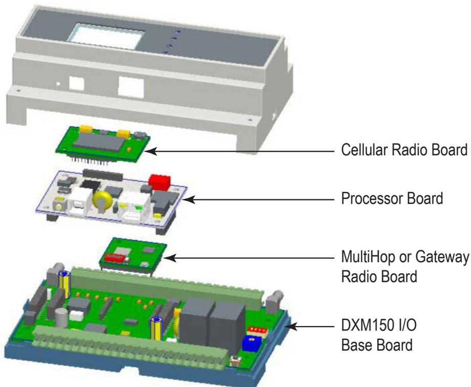
**Placa base de E/S:** La placa base de E/S del DXM proporciona conexiones para todas las entradas, las salidas y la alimentación. La placa base de E/S contiene un controlador solar de 12 V que acepta conexiones a un panel solar y a
