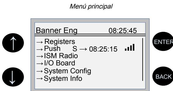
Se puede configurar el DXM para que sea necesario escribir un código de acceso antes de que funcionen la pantalla LCD y el sistema de menús. La configuración del código de acceso se define en el software de configuración de DXM.
