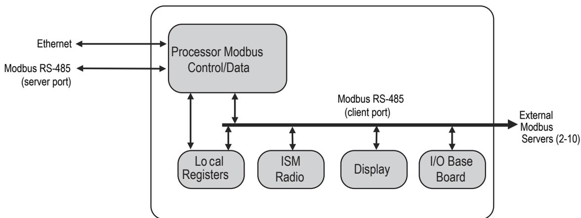
El DXM tiene dos funciones Modbus: un dispositivo de servidor Modbus y un dispositivo cliente Modbus. Se ejecutan como procesos independientes.
