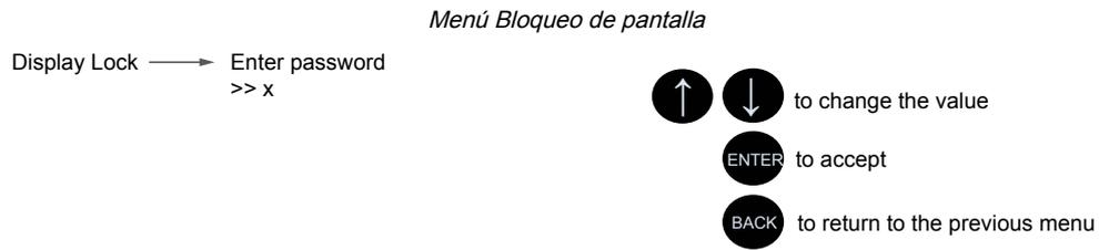
La función de bloqueo de pantalla utiliza el software de configuración para establecer un código de acceso dentro del DXM. Un código de acceso válido tiene entre 1 y 9 dígitos, y utiliza los números del 0 al 9. Por ejemplo, 1234 o 209384754.
