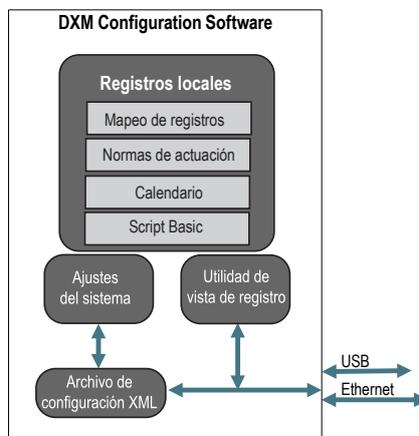
El software de configuración configura el cliente DXM al crear un archivo XML que se transfiere al cliente DXM mediante un conector USB o Ethernet. El cliente DXM también puede recibir el archivo de configuración XML desde un servidor web mediante una conexión celular o Ethernet.
