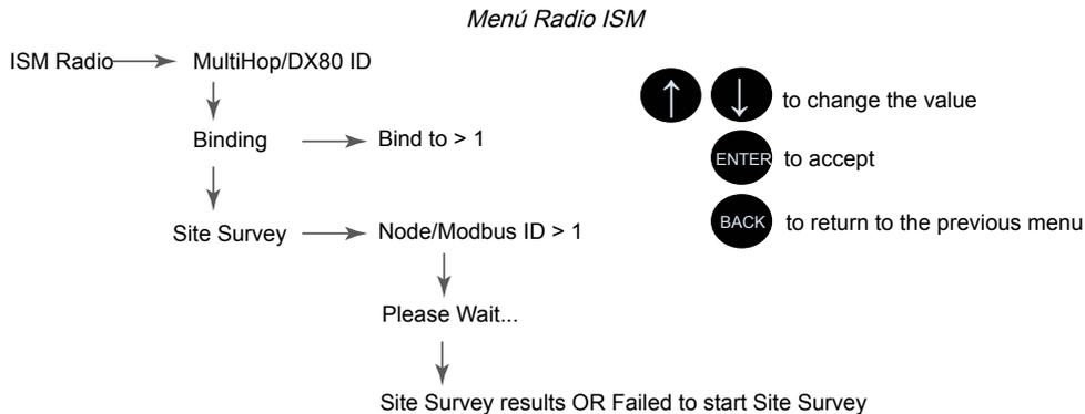
La primera opción del menú **Radio ISM** solo muestra el tipo de radio en el DXM (MultiHop o DX80 Star) y la ID de Modbus de la radio. Para cambiar la ID de Modbus de la radio ISM, vaya al menú **Sistema**.
