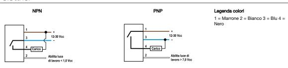
NOTA: In figura sono mostrati gli schemi per la versione con cavo. Gli schemi di collegamento per versione con connettore QD sono funzionalmente identici.
