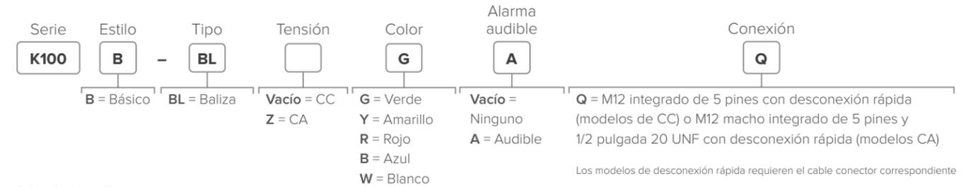
Los modelos de desconexión rápida requieren el cable conector correspondiente
