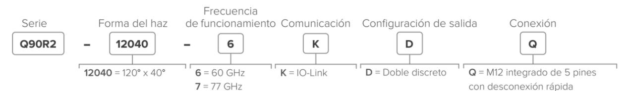
Los modelos de desconexión rápida requieren el cable conector correspondiente
