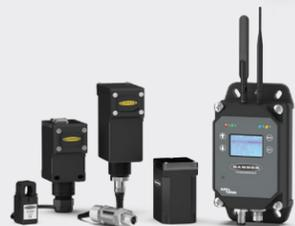
Überwachungs-Gateways sammeln Daten von unseren kompatiblen Sensoren, um Ihnen einen umfassenden Überblick über die Leistung der Anlagen zu geben. Banner bietet Überwachungsgateways an, die entweder über unsere SNAP ID-Technologie mit kabelgebundenen Sensoren oder über unsere CLOUD ID-Technologie mit drahtlosen Sensoren verbunden werden können.
