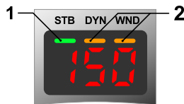
Imagen 2: Pantalla en modo Run (funcionamiento)
