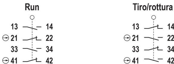
**Nota:** Questo simbolo per un contatto di sicurezza ad apertura forzata (IEC 60947-5-1) viene utilizzato nello schema dei circuiti per identificare il punto della corsa dell'attuatore in cui il contatto di sicurezza normalmente chiuso risulta completamente aperto.
