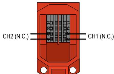
Pour garantir le meilleur niveau de fiabilité (Fiabilité de commande ou Catégorie 4, par exemple), câblez les contacts de sécurité à commande positive (bornes 21/22 et 41/42) dans un raccordement à deux voies vers un module de sécurité (par exemple, ES-FA-9AA), un contrôleur de sécurité (par exemple, XS/SC26 ou SC10-2roe), ou la partie de la commande de la machine liée à la sécurité qui est conforme au niveau de performance de sécurité requis.
