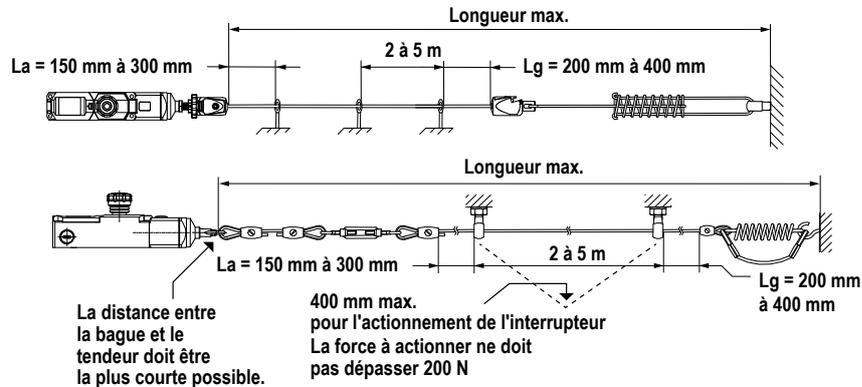
6. Pour les modèles **RP-LS42F-..LE avec tendeur intégré**:
