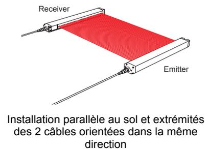
Figure 18. Exemples d'orientation incorrecte de l'émetteur et du récepteur
