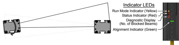
4. Pour optimiser l'alignement et améliorer le gain de détection, desserrez légèrement les vis de montage des capteurs et faites pivoter un capteur de gauche à droite en notant les positions dans chaque arc où les LED d'état
