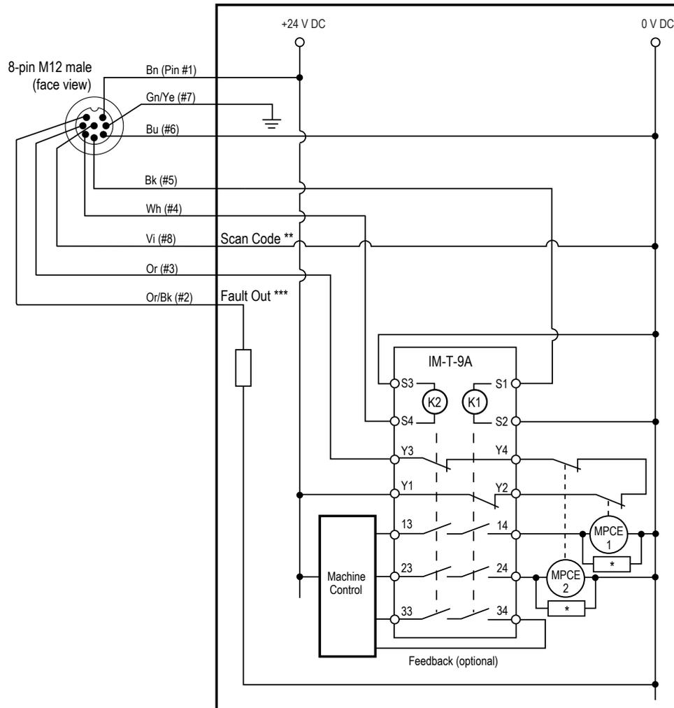
\* L'installation de supresseurs de parasites entre les bobines de MPCE1 et de MPCE2 est recommandée (voir l'avertissement).
