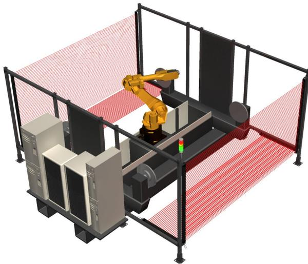
Figure 50. Barrières immatérielles en cascade protégeant une cellule en U
