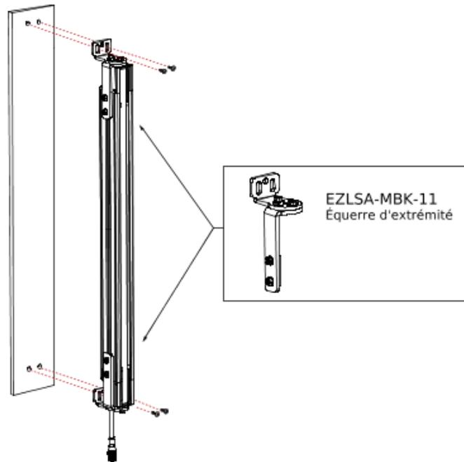
1. Partant d'un point de référence commun (en respectant la distance de sécurité minimale calculée), placez l'émetteur et le récepteur sur le même plan avec leurs axes centraux directement opposés et, le cas échéant, repérez et forez des trous de fixation.
