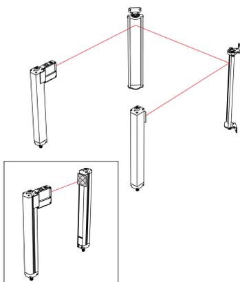
Figure 33. Alignement des miroirs d'angle
