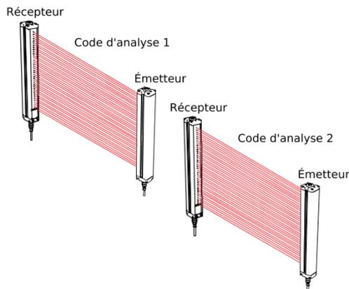
Figure 20. Deux ou trois systèmes superposés (ou positions alternées des récepteurs/émetteurs)
