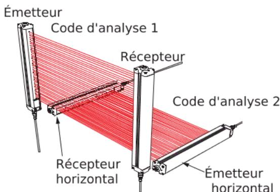
Figure 22. Plusieurs systèmes installés en ligne
