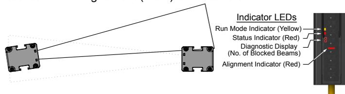
3. Si la LED d'état verte et la LED du mode RUN jaune sont allumées, passez à l'étape suivante. Si ce n'est pas le cas, faites pivoter chaque capteur (un à la fois) à gauche et à droite jusqu'à ce que la LED d'état verte soit allumée. (Lorsque le capteur n'est pas correctement aligné, la LED d'état rouge s'allume). À mesure de l'alignement des faisceaux, les LED d'alignement passent du rouge au vert et le nombre de faisceaux bloqués diminue.
