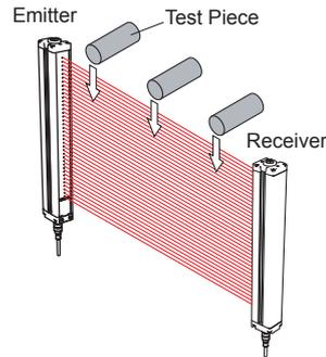
4. Vérifiez qu'à chaque passage, lorsque la pièce de test interrompt la zone de détection, **au moins une LED d'alignement passe au rouge. La LED d'alignement rouge doit changer selon l'emplacement de la pièce de test dans la zone de détection.**
