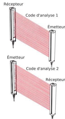
Figure 21. Deux systèmes installés à angle droit
