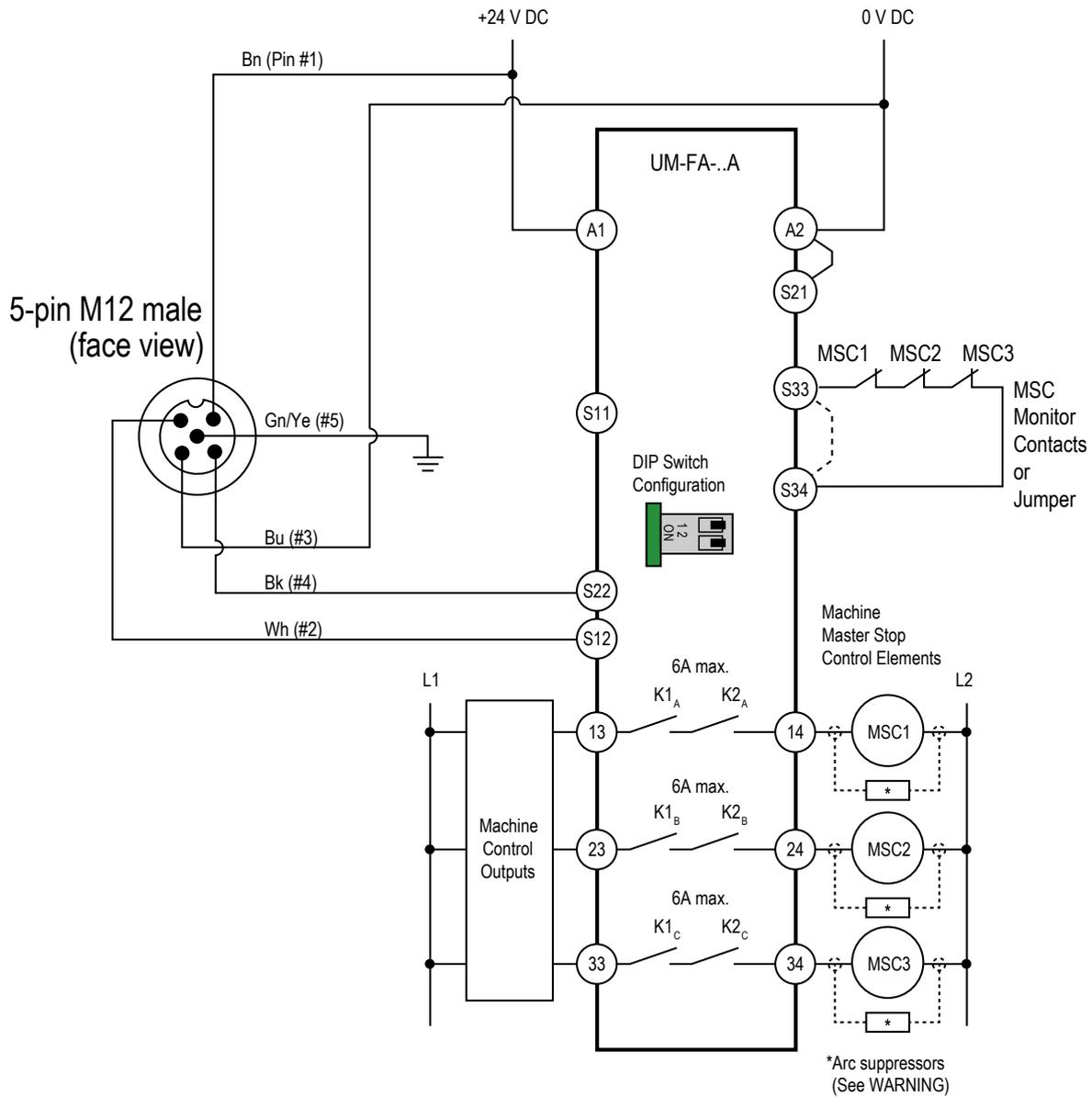
Figure 42. Schéma de câblage générique - Module UM-FA...A avec reset manuel
