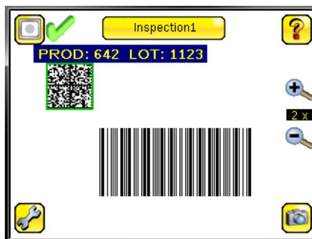
Pour les déclenchements suivants, lorsque le capteur lira les données de code-barres, il les comparera à ces données de référence.
