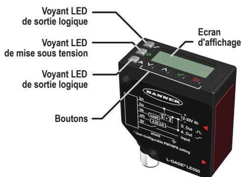
Illustration 1. Caractéristiques du capteur analogique LE
