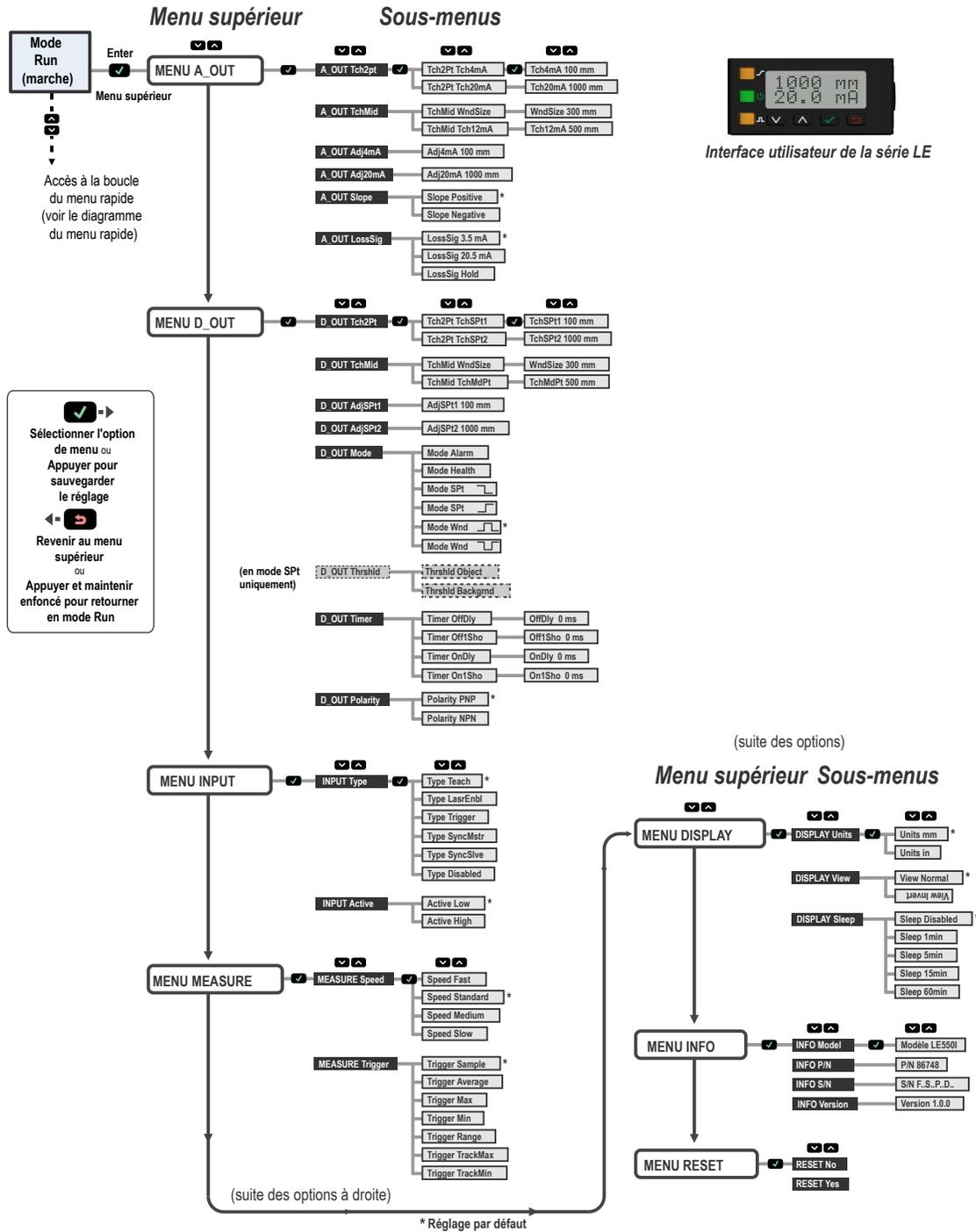
Illustration 14. Schéma du menu du capteur LE550 (modèles analogiques)
