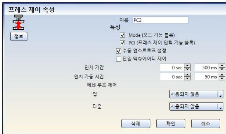
프레스 제어 기능 블록에 추가할 수 있는 추가 노드는 고유한 새 기능 블록을 생성합니다. 모드 특성을 선택한 경우 모드 기능 블록이 추가됩니다. PCI 특성 상자를 선택한 경우 프레스 제어 입력 기능 블록이 추가됩니다. 다른 2가지 특성인 수동 업 스트로크 설정과 단일 액추에이터 제어는 둘 다 선택할 수 없습니다.
