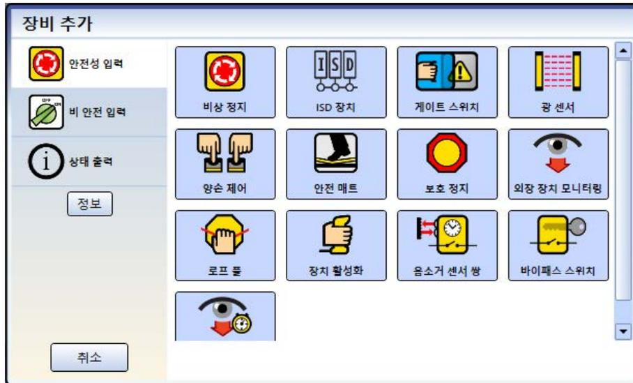
그림 57: 비안전 입력(가상 비안전 입력은 **Functional View(기능 보기)** 탭에서만 사용할 수 있음)
