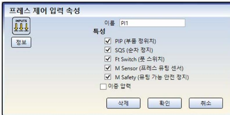
PCI 블록의 기본 노드는 **PIP**(부품 제위치) 입력, **SQS**(순차 정지) 입력 및 **M 안전**(유틙 가능 안전 정지) 입력입니다. **Audience=Banner SQS**를 선택하면 **풋 스위치**(발판 스위치) 및 **M 센서**(유틙 센서 누름) 입력을 옵션으로 사용할 수 있으며 이중 압력 속성을 사용할 수 있습니다(이를 통해 표준 상하 출력에 고압 및 저압 출력을 추가할 수 있습니다).
