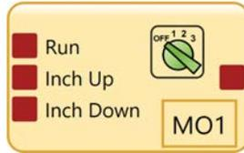
프레스 제어 기능 블록에서 모드 기능 블록을 선택하면 프레스 제어 기능 블록에 인치 기간 및 인치 온타임이 추가됩니다. 이러한 매개변수는 시스템에서 (일반적으로 설정 모드 중 사용되는) 인칭 중 프레스가 너무 빠르게 움직이지 않도록 하기 위한 사용자 정의 값입니다.
