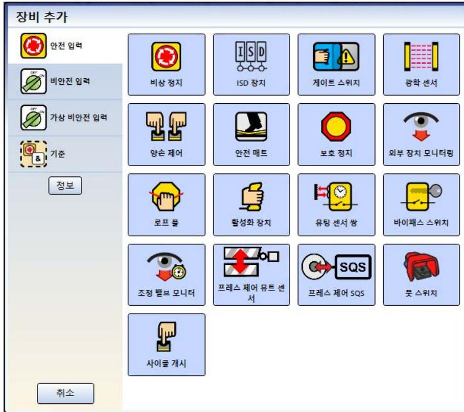
그림 56: SC10-2: 장비 보기에서 입력 추가(물리적 상태 출력은 이 보기에서만 추가 가능)
