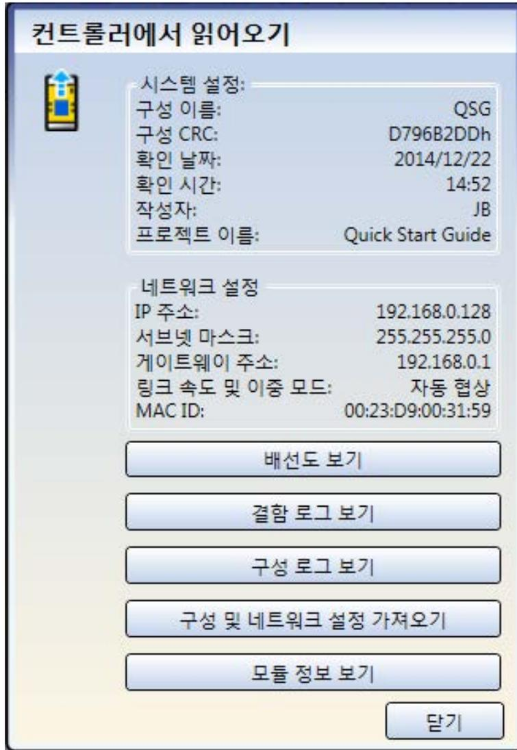
**배선도 보기** - 소프트웨어에서 다른 모든 탭과 워크시트를 제거하고 **Wiring Diagram(배선도)** 및 **Equipment(장비)** 탭만 표시합니다.
