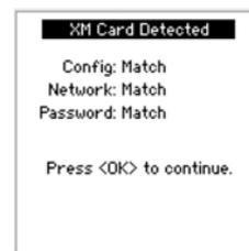
또한, 네트워크 설정이 일치하지 않는 경우(XS/SC26-2de 모델) 안전 컨트롤러의 네트워크 설정이 SC-XM2/3으로 전송됩니다. 전송이 완료되면 디스플레이에 다음과 같이 표시됩니다.
