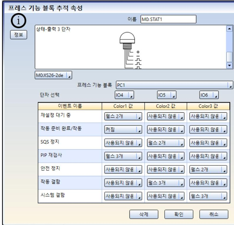
프레스 기능 블록의 기본 설정은 3가지 IO 핀을 상태 출력으로 구성합니다. 특정 적용 분야에서 7가지 이벤트를 모두 표시할 필요가 없는 경우 그림의 오른쪽에 있는 슬라이드 막대를 사용하여 더 적은 수의 핀을 선택합니다. 슬라이드 막대를 한 위치 위로 올리면 단자 수가 2개로 줄어들고, 이 막대를 2개 위치 위로 이동하면 단자 수가 1개로 줄어듭니다.
