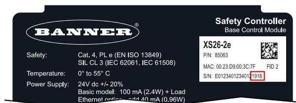
1. Controllare l'etichetta con il numero di modello e prendere nota del numero FID e del codice della data. Il codice della data corrisponde alle 4 ultime cifre del numero di serie del modulo di sicurezza. Nell'esempio mostrato, "19" sta per 2019 e "18" indica la diciottesima settimana.
