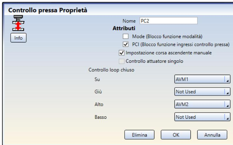
In questo esempio, il controllo a loop chiuso è impostato per assicurare che la valvola di uscita Up sia disattivata prima di consentire qualsiasi altra funzione. Assicura inoltre che la valvola High chiuda prima di impegnare l'uscita Up.
