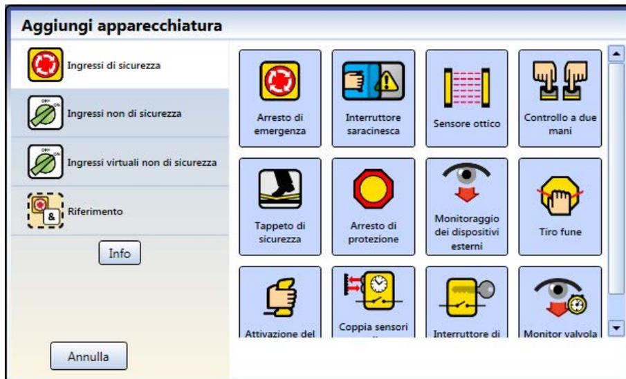
Figura 51. SC10-2: Aggiunta di ingressi dalla vista Apparecchiatura (le uscite di stato fisiche possono essere aggiunte soltanto da questa vista)
