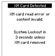
Se l'SC-XM2/3 non viene disconnesso dal modulo di sicurezza entro 3 secondi, il modulo di sicurezza passa allo stato di blocco:
