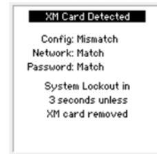
Se l'SC-XM2/3 non viene scollegato dal modulo di sicurezza entro 3 secondi, il modulo di sicurezza entra in uno stato di blocco
