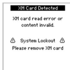
7. Se il modulo di sicurezza è passato allo stato di blocco, rimuovere l'SC-XM2/3 e togliere e riapplicare tensione o eseguire un reset di sistema.
