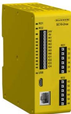
Il modulo di controllo a relè di sicurezza configurabile SC10-2 è un'alternativa semplice ed economica ai moduli relè di sicurezza. Sostituisce la funzionalità e la capacità di due moduli relè di sicurezza indipendenti, offrendo al contempo la configurabilità, la semplicità e le capacità di diagnostica avanzata offerte dal resto della linea di moduli di controllo di sicurezza di Banner.
