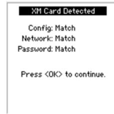
Wenn die Netzwerkeinstellungen nicht übereinstimmen (Modelle XS/SC26-2de), werden die Netzwerkeinstellungen des Sicherheitskontrollers auf das SC-XM2/3 übertragen. Wenn dies abgeschlossen ist, zeigt das Display Folgendes an:
