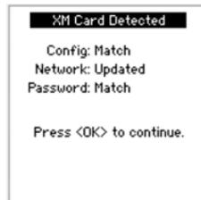
Auf **OK** klicken. Schlägt die Aktualisierung fehl (z. B. weil das SC-XM2/3 gesperrt ist), wird auf dem Display der Grund für den Fehler angezeigt und bis zu einer Systemsperre heruntergezählt:
