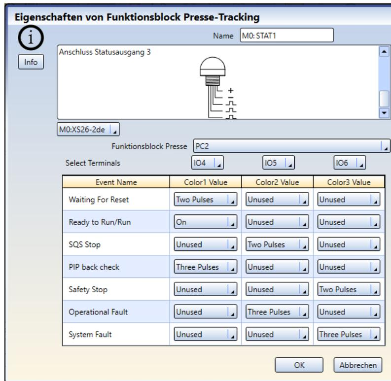
Die Standardeinstellung des Funktionsblocks konfiguriert drei der IO-Pins als Statusausgänge. Wenn für eine bestimmte Anwendung nicht alle sieben Ereignisse angezeigt werden müssen, verwenden Sie den Schieberegler rechts neben der Abbildung, um weniger Pins auszuwählen. Durch Verschieben des Balkens um eine Position nach oben wird die Anzahl der Anschlüsse auf zwei reduziert, durch Verschieben des Balkens um zwei Positionen nach oben wird die Anzahl der Anschlüsse auf einen reduziert.
