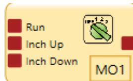
Wenn der Modus-Funktionsblock im Pressensteuerungs-Funktionsblock ausgewählt wird, werden dem Pressensteuerungs-Funktionsblock die Dauer und Einschaltzeit der Schrittsteuerung hinzugefügt. Bei diesen Parametern handelt es sich um benutzerdefinierte Werte für ihr System, um sicherzustellen, dass sich die Presse bei der Schrittsteuerung nicht zu schnell bewegt (typischerweise während der Einrichtungsmodi verwendet).
