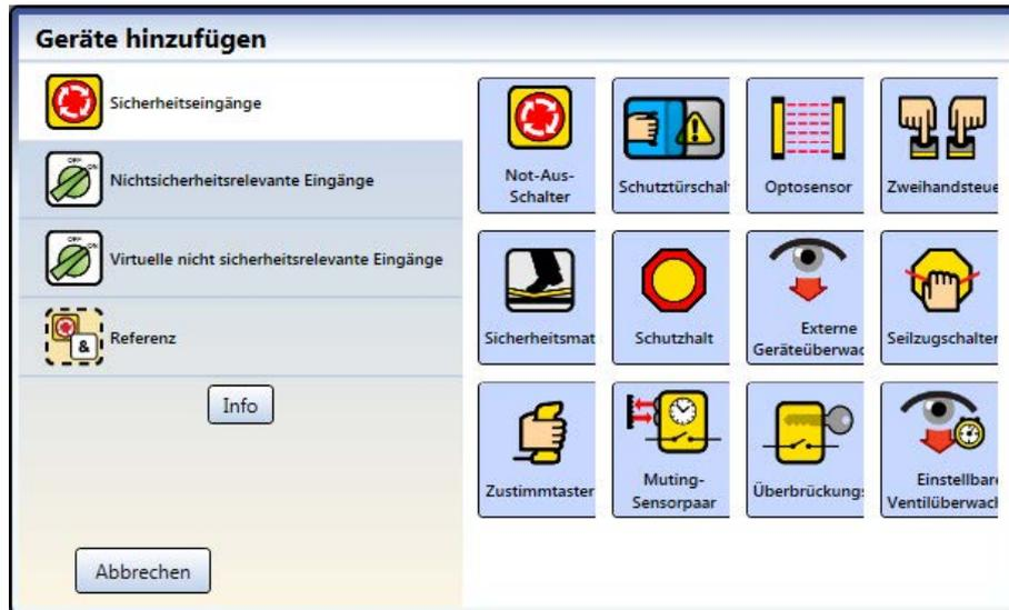
Abbildung 51. SC10-2: Hinzufügen von Eingängen aus der Geräteansicht (physischer Statusausgang kann nur aus dieser Ansicht hinzugefügt werden).
