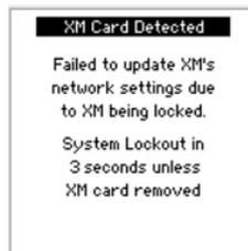
Wird das SC-XM2/3 nicht innerhalb von 3 Sekunden vom Sicherheitskontroller getrennt, geht der Sicherheitskontroller in einen Sperrzustand über:
