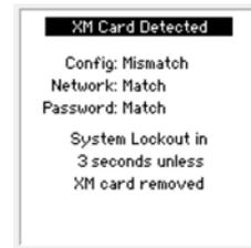
Wenn das SC-XM2/3 nicht innerhalb von 3 Sekunden vom Sicherheitskontroller getrennt wird, geht der Sicherheitskontroller in einen Sperrzustand über:
