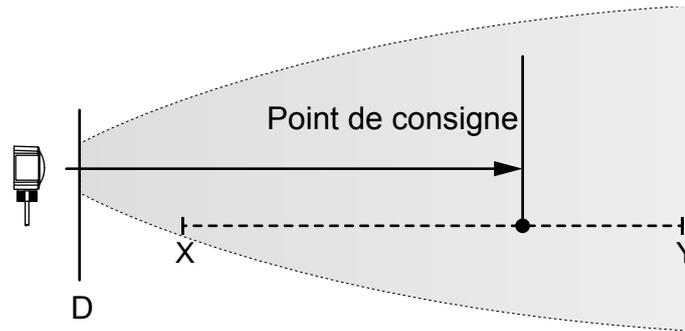
Distances de consigne minimale et maximale du R-GAGE (le capteur détecte les objets jusqu'à la consigne et ignore les objets situés au-delà.)
