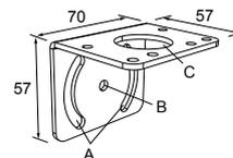
Distance entre les axes des trous : A = 51, A à B = 25,4
