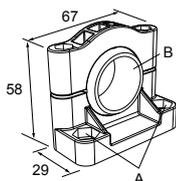
Distance entre les axes des trous : A=ø 50,8
