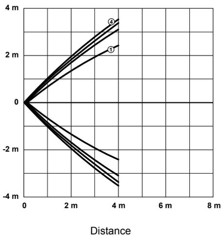
**Forme normale du faisceau (avec 4 cibles différentes) au niveau de sensibilité maximum**
