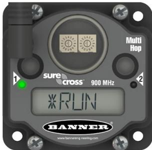
Cuando se aplica la alimentación, la radio MultiHop comienza a funcionar. La pantalla se desplaza automáticamente por el menú \*RUN y se activa la comunicación entre los dispositivos. El desplazamiento automático por el menú \*RUN es el modo de funcionamiento normal para todos los dispositivos de la red inalámbrica.
