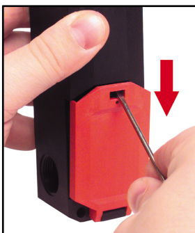
Abbildung 4. Öffnen des Verdrahtungsraums
