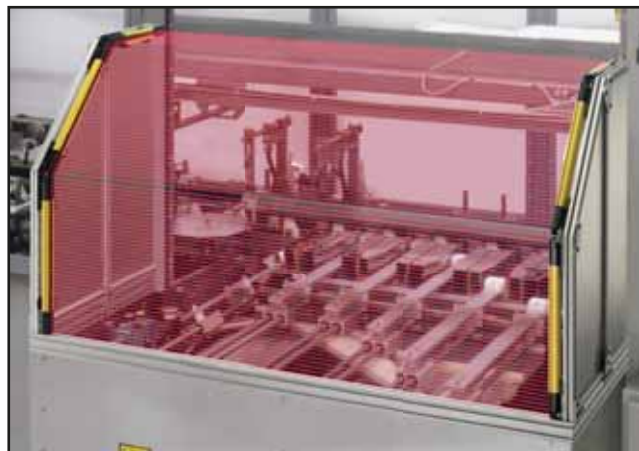
Figura 7-1. Barriere ottiche multiple collegate in cascata usate per proteggere l'apertura di forma irregolare di una macchina
