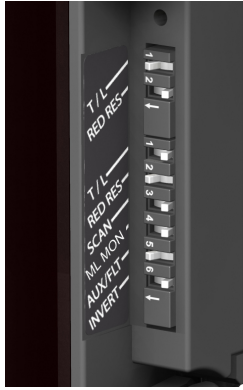
그림 20: 유팅 구성 옵션을 프로그래밍하기 위한 DIP 스위치 설정
