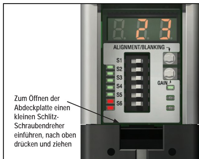
Abbildung 4-1. Empfänger-Benutzeroberfläche. HINWEIS: Alle DIP-Schalterpositionen sind im AN-Zustand dargestellt.
