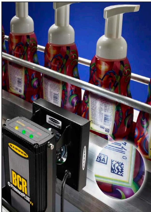
Figura 2-1. Applicazione tipica del sensore PresencePLUS P4 BCR
