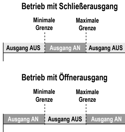
Abbildung 3. Programmierung der unabhängigen unteren und oberen Grenzwerte
