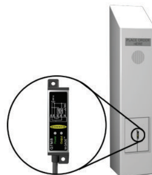
Figura 3. Installazione utilizzando i fori di montaggio nei tappi terminali del sensore
