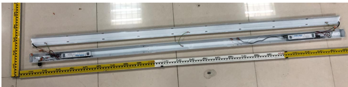
WLB72BZCW2400DACT 120W (600 × 0.3W/LED) 内部结构
