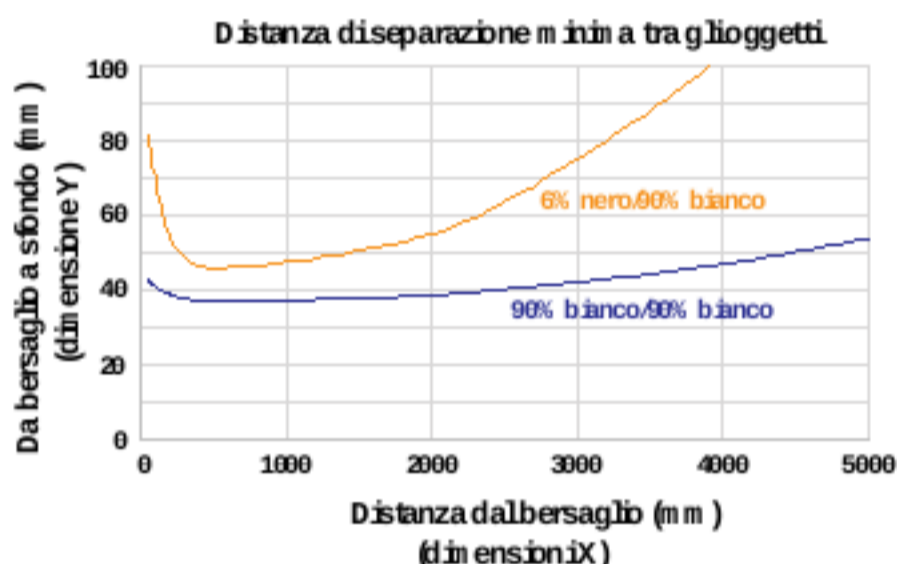
Figura 27. Distanza di separazione minima tra gli oggetti per tempo di risposta 5 ms
