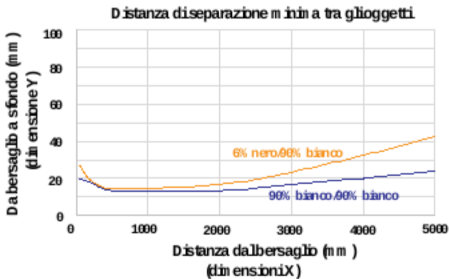
Figura 23. Distanza di separazione minima tra gli oggetti per tempo di risposta 50 ms
