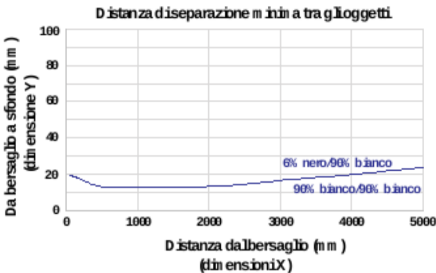
Figura 21. Distanza di separazione minima tra gli oggetti per tempo di risposta 250 ms
