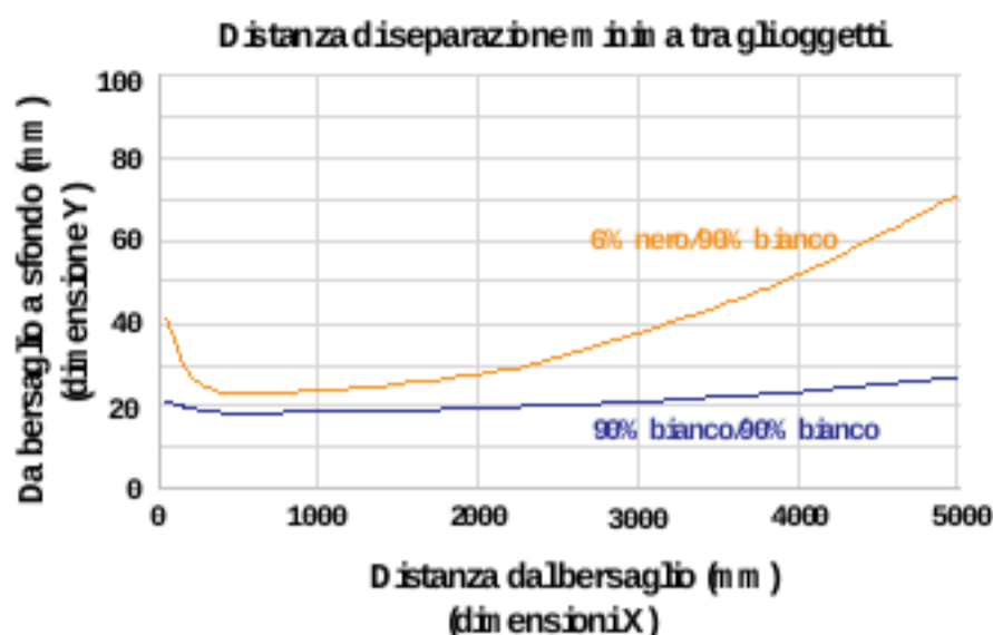
Figura 25. Distanza di separazione minima tra gli oggetti per tempo di risposta 15 ms
