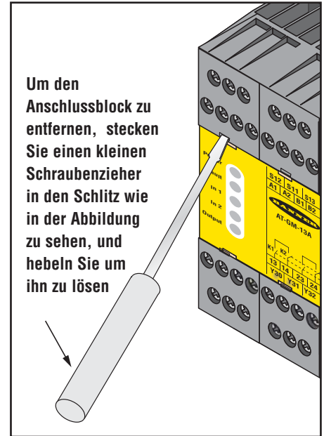
Abb. 7 Entfernen des Anschlußblocks
