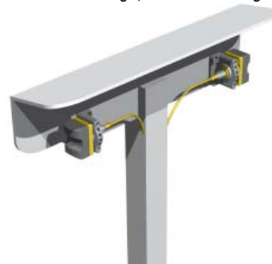
Abb. 4 Die STB-Taster sind so zu montieren, dass eine unbeabsichtigte Betätigung oder eine absichtliche Umgehung nicht möglich ist
