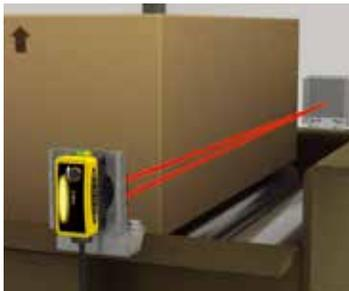
使用鏡片反射式感測器在包裝箱輸入口進行檢測
