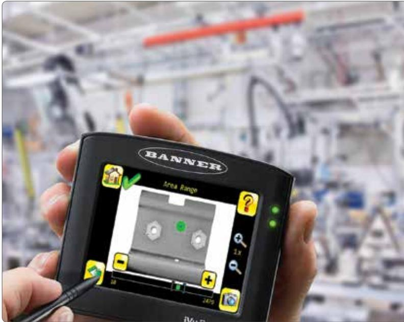
能夠在進行檢測的同時設定並調整感測器，而無須重新啟動感測器以進行檢測，可為您省下寶貴的時間
