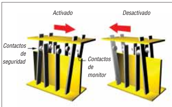
Figura 5: Contactos guiados positivamente
