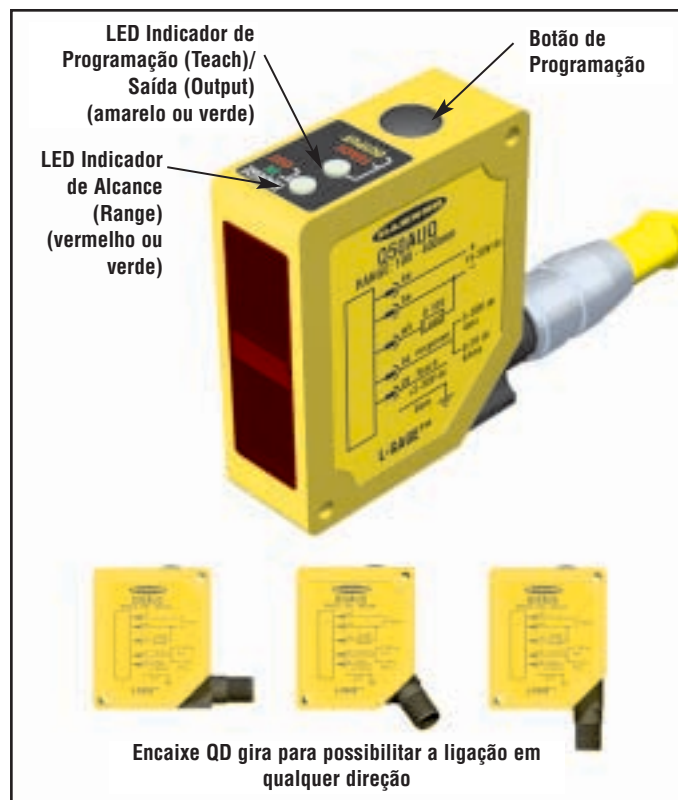
Figura 2. Características do sensor L-GAGE Q50A
