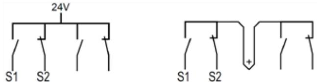
2x補助（PNPデバイス）：バイパススイッチの設計と設置に応じてこの回路は、ISO 13849-1カテゴリ4の必要条件を満たすことができます。この回路は、チャンネル間のショートを検出することができます。作動状態で（例：S1 OFF/S2 ON）、閉じた接点を超えるショートは、応答時間にデバウンスタイムに基づいて増加をもたらす場合があります。この状況で、応答時間は（選択された）デバイ運タイムに基づき、指定より長くなる場合があります。セクション3.2.2をご参照下さい。
