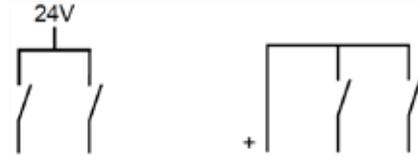
デュアルチャンネル（PNPデバイス）：出力デバイスの安全定格、設置、そして故障検出（例：ショート）性能に応じて、この回路は、ISO 13849-1カテゴリ2、3、または4の必要条件を満たす事ができます。セーフティコントローラは、この構成でショート検出を提供しません。
