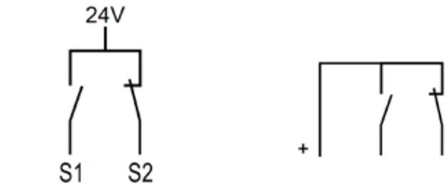
補助（PNPデバイス）：入力デバイスの安全定格と設置に応じてこの回路は、ISO 13849-1カテゴリ2、3、または4の必要条件を満たす事ができます。この回路は、チャンネル間のショートを検出する事ができます。作動状態で（例：S1 OFF/S2 ON）、閉じた接点を超えるショートは、応答時間にデバウンスタイムに基づいて増加をもたらす事があります。この状況で応答時間は（選択された）デバイ運タイムに基づき、指定程長くなる事があります。セクション3.2.2をご参照下さい。
