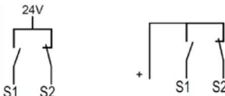
補助（PNPデバイス）：出力デバイスの安全定格と設置に応じてこの回路は、ISO 13849-1カテゴリ2、3、または4の必要条件を満たす事ができます。この回路は、チャンネル間のショートを検出する事ができます。作動状態で（例：S1 OFF/S2 ON）、閉じた接点を超えるショートは、応答時間にデバウンスタイムに基づいて増加をもたらす事がありません。この状況で応答時間は（選択された）デバイ運タイムに基づき、指定程長くなる事がありません。セクション3.2.2をご参照下さい。
