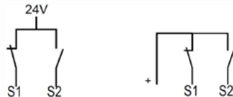
補助（PNPデバイス）：出力デバイスの安全定格と設置に応じてこの回路は、ISO 13849-1カテゴリ2、3、または4の必要条件を満たす事ができます。この回路は、チャンネル間のショートを検出する事ができます。作動状態で（例：S1 ON /S2 OFF）、閉じた接点を越えるショートは、応答時間にデバウンスタイムに基づいて増加をもたらす事があります。この状況で応答時間は（選択された）デバイスタイムに基づき、指定より長くなる事があります。セクション3.2.2をご参照下さい。
