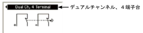
端子アサインの編集—入力回路タイプが選択されると、セーフティコントローラは自動的に次の利用できる端子台を入力デバイスに割り当てます。これらの端子アサインを確認し変更するためには、端子台の変更を選択しOKを押して下さい。
