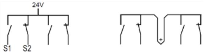
2x補助（PNPデバイス）：イネーブリングデバイスの設計と設置に応じてこの回路は、ISO 13849-1カテゴリ3かカテゴリ4の必要条件を満たす事ができます。この回路は、チャンネル間のショートを検出する事ができます。作動状態で（例：S1 OFF/S2 ON）、閉じた接点を超えるショートは、応答時間にデバウンスタイムに基づいて増加をもたらす事がありません。この状況で応答時間は（選択された）デバイ運タイムに基づき、指定より長くなる事がありません。セクション3.2.2をご参照下さい。
