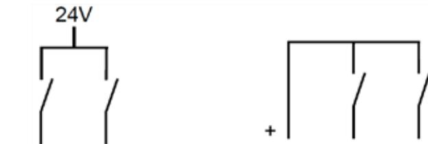
デュアルチャンネル（PNPデバイス）：入力デバイスの安全定格、設置、そして故障検出（例：ショート）性能に応じて、この回路は、ISO 13849-1カテゴリ2、3、または4の必要条件を満たす事ができます。セーフティコントローラは、この構成でショート検出を提供しません。
