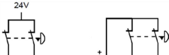
デュアルチャンネル（PNPデバイス）：スイッチの安全定格、設置、そして故障検出（例：ショート）性能に応じてこの回路は、ISO 13849-1カテゴリ2、3、または4の必要条件を満たす事ができます。セーフティコントローラは、この構成でショート検出を提供しません。
