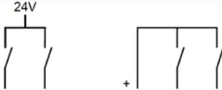
デュアルチャンネル（PNPデバイス）：イネーブリングデバイスの安全定格、設置、そして故障検出（例：ショート）性能に応じてこの回路は、ISO 13849-1カテゴリ2、3、または4の必要条件を満たす事ができます。セーフティコントローラは、この構成でショート検出を提供しません。
