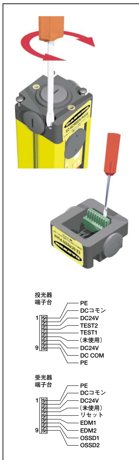
Fig.3-12 端子台への接続
