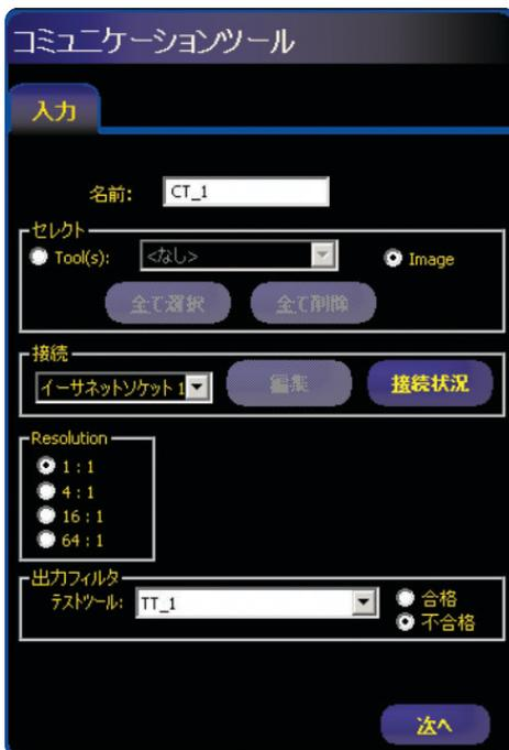
エクスポートした画像は、標準のBMP形式です。画像はイーサネットで転送されます。シリアル通信はサポートされていません。画像はセンサからPCにバイナリ形式で転送されます。Bannerが定義したヘッダ(フレーム数および画像のバイト数を格納)が、BMPデータと共に送信されます。
