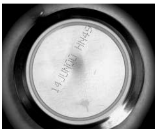
ドームライトによる缶の底の映像
