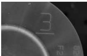
ローアングルライトによるエッチングの映像
