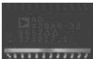
指向性照明によるICチップの映像
