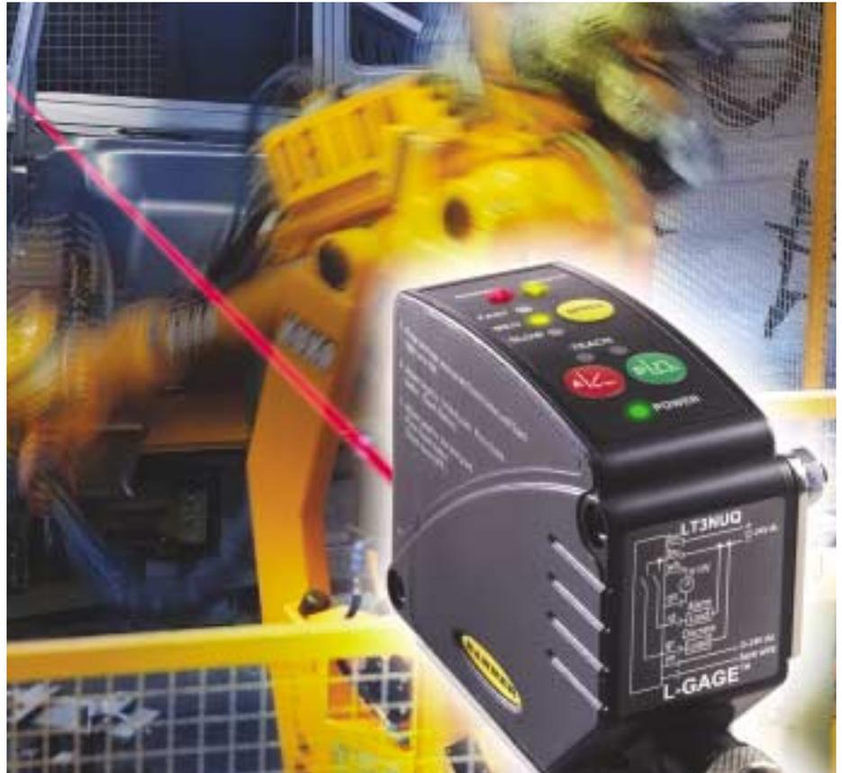
Der LT3 verwendet Laser-Laufzeittechnologie und ist somit extrem leistungsfähig. Der Laser pulsiert eine Million Mal pro Sekunde. Der Mikroprozessor zeichnet die Impulslaufzeit zum Erfassungsobjekt hin und zum Sensor zurück auf. Pro Millisekunde werden eintausend Impulslaufzeiten gemittelt und der entsprechende Wert wird an den Ausgang weitergeleitet.
