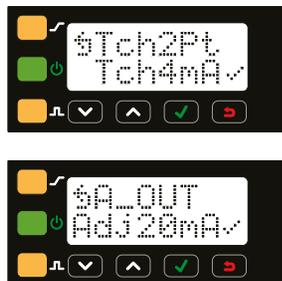
Il est possible d'utiliser diverses méthodes d'apprentissage pour régler la fenêtre analogique du détecteur LTF.
