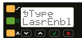
L'entrée déportée est utilisée pour désactiver l'émetteur si des opérateurs sont présents dans la cellule.
