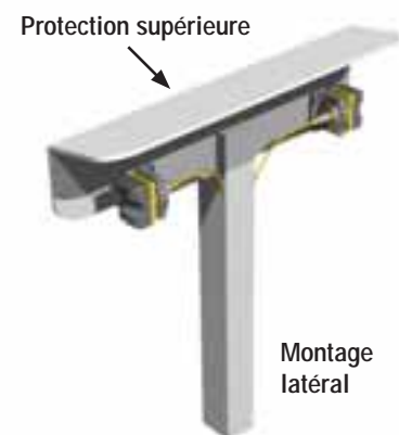
Figure 3. Installer les dispositifs d'actionnement pour qu'ils soient protégés contre une utilisation frauduleuse ou accidentelle (l'illustration représente des boutons tactiles Banner STB)
