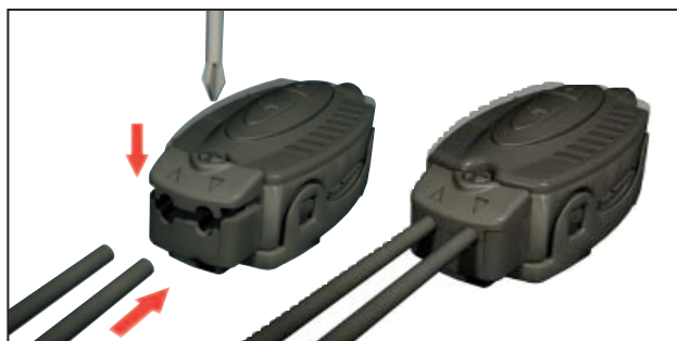
圖2.安裝塑料光纖:
