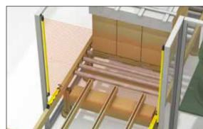
**4 带屏蔽功能的卸托盘机防护**
