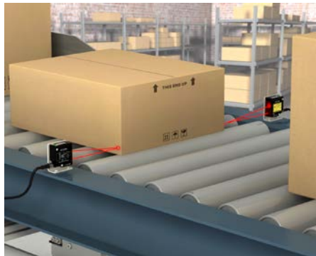
分拣线中检测物体的尺寸
