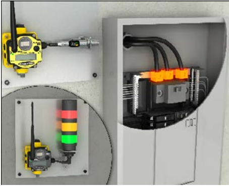
红外测温，监控关键设备工况并指示
