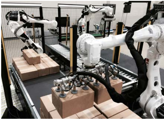
物流线机器人搬运码垛
