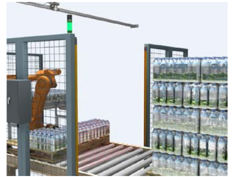
视觉相机对包装数量进行确认，塔灯实时显示检测结果
