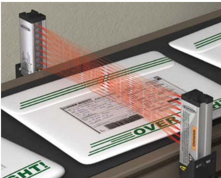
分拣线中信封等薄物件的检测
