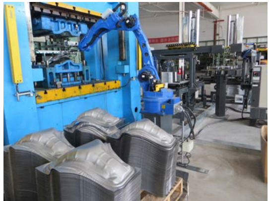
机器人压机上下料
