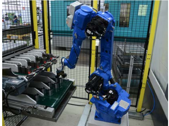
机器人机床上下料
