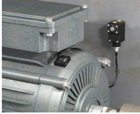
电机振动及温度监测
