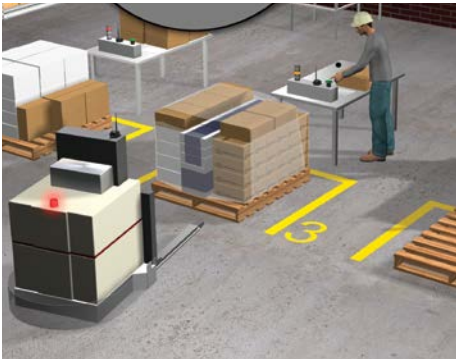
通过按钮来规划AGV小车货盘的装卸
