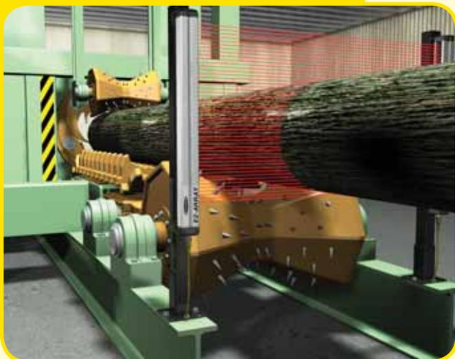
Objetivo: determinar o diâmetro de uma tora antes de ela entrar em uma estação usada para remoção da casca.
