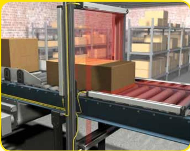
Objetivo: medir a altura, comprimento e largura de caixas para armazenamento e coletar informações de perfil para carregamento.
