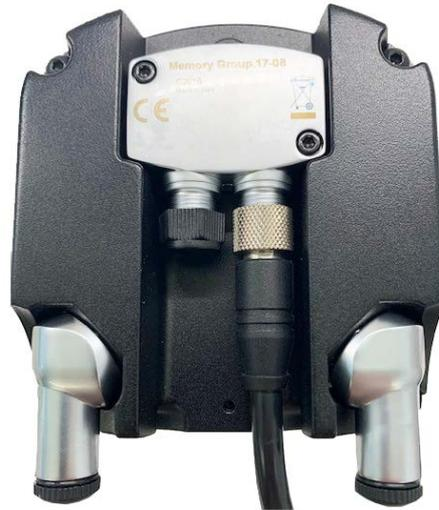
7. Reinstallare il coperchio di protezione e serrare le due viti per fissarlo in posizione (la coppia di serraggio è 0,5 N-m).
