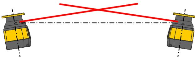
Figura 21. Scanner installati con altezze di scansione diverse
