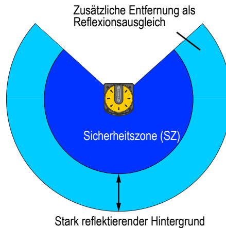
Abbildung 24. Stark reflektierenden Hintergrund reduzieren oder entfernen
