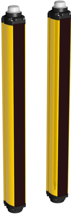
Il Sistema di sicurezza multiraggio SGS con muting integrato di Banner è una barriera optoelettronica in modalità emettitore/ricevitore, controllata da microprocessore, ridondante e composta da due pezzi. I modelli standard sono disponibili con 2 raggi (distanza tra i raggi 500 mm), 3 raggi (distanza tra i raggi 400 mm) o 4 raggi (distanza tra i raggi 300 mm e 400 mm).
