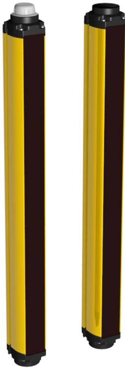
Il Sistema di sicurezza multiraggio SGS con muting integrato di Banner è una barriera ottica optoelettronica a riflessione, controllata da microprocessore, ridondante e composta da due pezzi. I modelli standard sono disponibili con 2 raggi (distanza tra i raggi 500 mm), 3 raggi (distanza tra i raggi 400 mm) o 4 raggi (distanza tra i raggi 300 mm e 400 mm).
