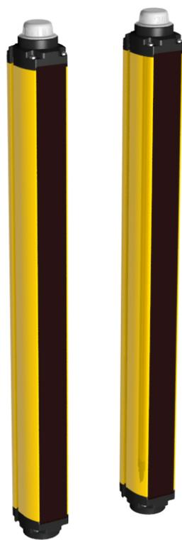
Le Système SGS (Safety Grid System) de Banner est un « rideau lumineux » composé de deux éléments (émetteur et récepteur), encore appelé « barrière immatérielle de sécurité ». Redondant, il fonctionne selon le principe d'une barrière optoélectronique et est contrôlé par microprocesseur. Les modèles standard sont des systèmes à 2 faisceaux (espacement des faisceaux de 500 mm), à 3 faisceaux (espacement des faisceaux de 400 mm) ou à 4 faisceaux (espacement des faisceaux de 300 mm et 400 mm).
