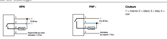
Remarque: Les schémas de raccordement des câbles sont illustrés. Les schémas de raccordement des modèles avec raccord QD sont identiques.
