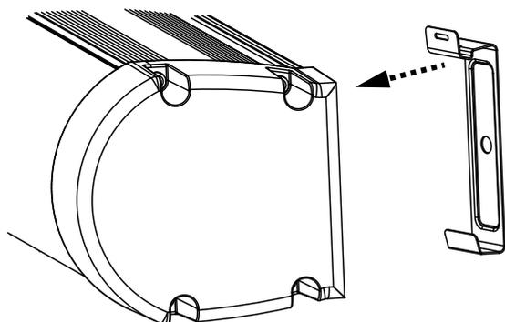
Imagen 1: Colocación de soportes a presión (paso 6)
