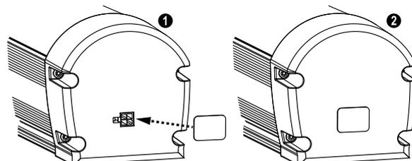
Imagen 2: Instalación de cubierta en cascada (paso 9)
