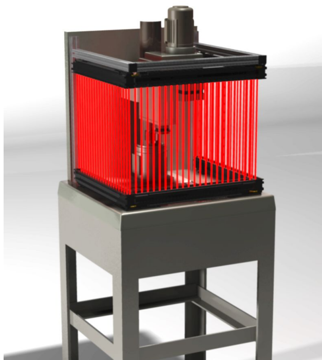
Figura 49. Barriere ottiche che proteggono una cella robotica
