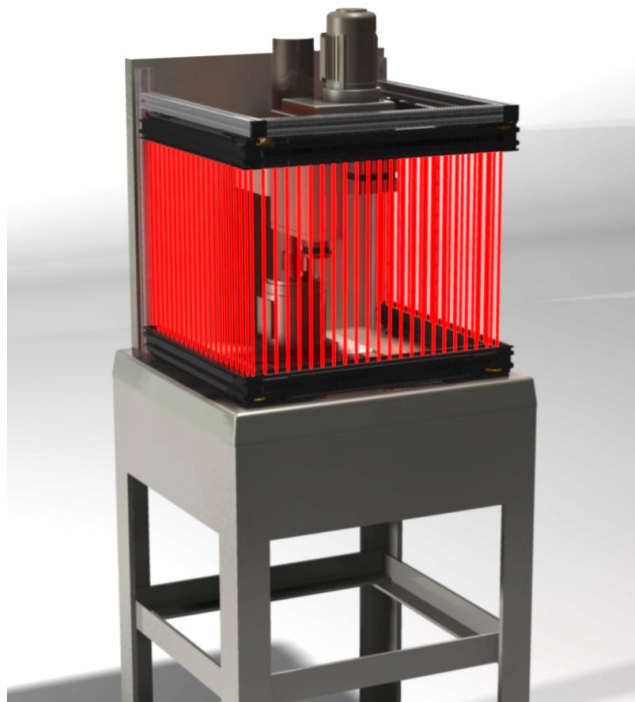
Abbildung 50. Kaskadierte Lichtvorhänge zum Schutz einer u-förmigen Roboterzelle
